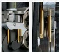
Los pasadores de la guía de entrada de fricción **ultra baja** facilitan la carga del alambre sin deformarlo en el camino hacia los rodillos de alimentación, lo cual mejora el rendimiento de la alimentación.
