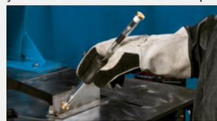
**La herramienta de calibración** es fácil de usar y permite colocar la muestra de soldadura en cualquier posición, lo que alerta al sistema de la ubicación exacta de la unión.
