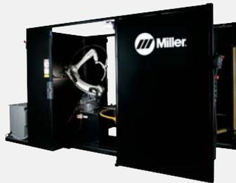
**PA250M** tablero con indexación manual de 250 lb (113 kg)/lado; 60 pulg. (1524 mm)
