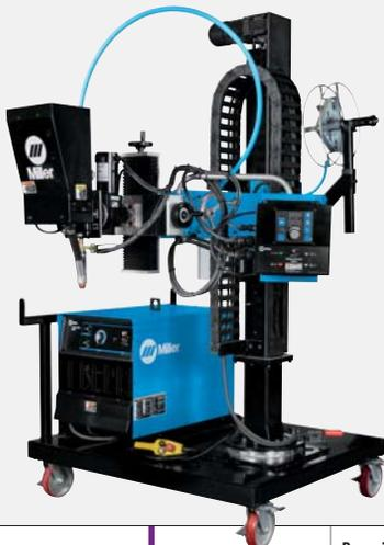
Se muestra el sistema portátil SubArc DC 650 digital.
