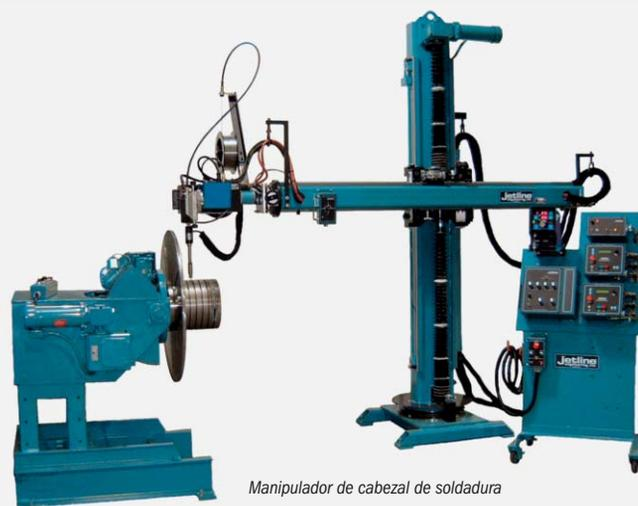
Manipulador de cabezal de soldadura
