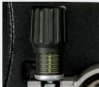
La escala graduada de la perilla reguladora de presión del alambre proporciona un ajuste fácil y una presión uniforme en los rodillos y el alambre.
