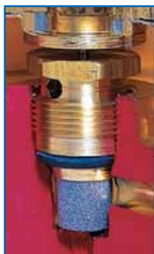
Asiento de una pieza encapsulado con filtro interno
