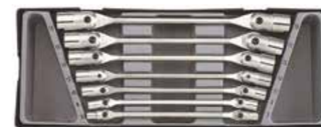
T5074: Juego de 7 llaves de vaso articuladas de 6x7, 8x9, 10x11, 12x13, 14x15, 16x17 y 18x19mm.
