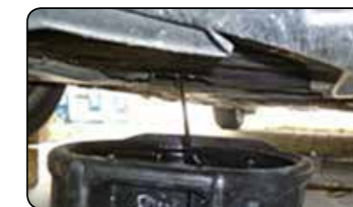
Drenaje de fluidos
