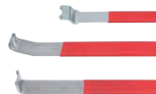
■ 903G15 P. J-32 Juego para tensado de correas de alternador VAG
